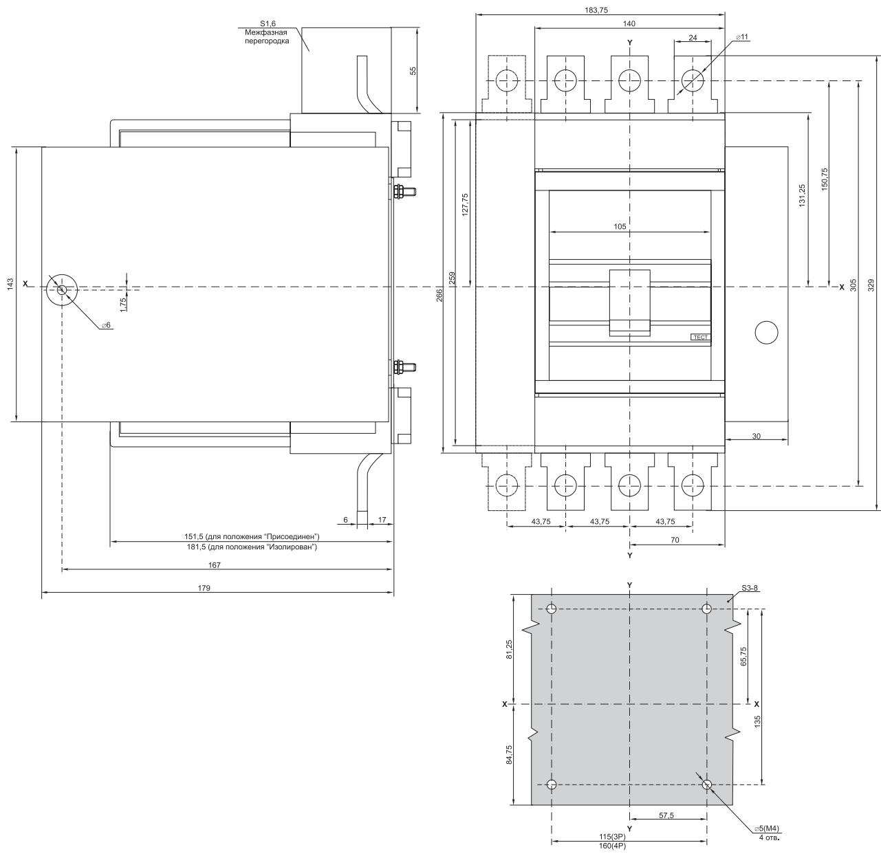
**ВА88-37 с выдвижными панелями заднего резьбового присоединения
