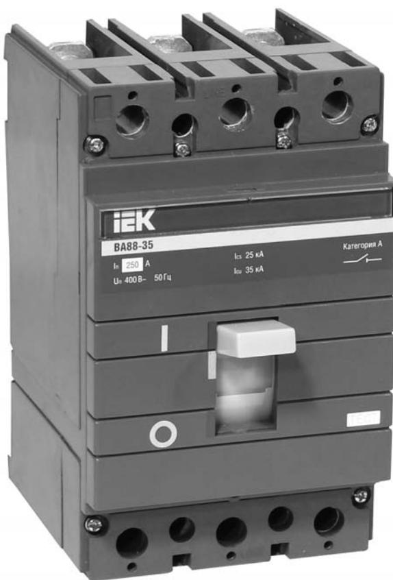
Автоматические выключатели серии BA88 предназначены для проведения тока в нормальном режиме и отключения тока при коротких замыканиях, перегрузках, недопустимых снижениях напряжения в трехфазных электрических сетях переменного тока напряжением до 400 В частотой 50 Гц.
