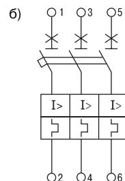
б) с тепловым и электромагнитным расцепителем
