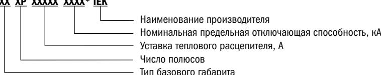
Пример обозначения выключателя при заказе и в документации другого изделия: выключатель автоматический в исполнении 33-го габарита трехполюсный на номинальный ток 125 А с номинальной предельной отключающей способностью 35 кА торговой марки IEK® – BA88-33 ЗР 125А 35кА ИЭК.
