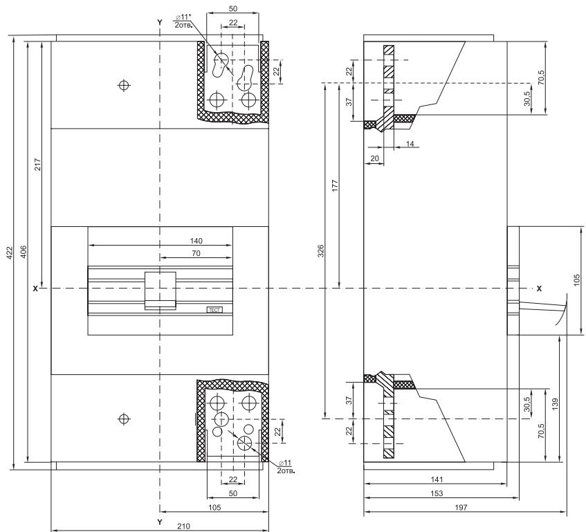
\*Отверстия предназначены для крепления наконечника-переходника
