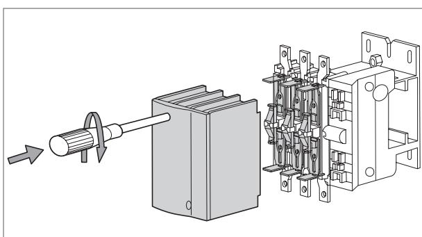
Крышка контактора, закрывающая контактную систему, легко снимается (2 подпружиненных винта поворачиваются на 90°). Это облегчает монтаж/демонтаж дугогасительных камер и упрощает сервисное обслуживание.
