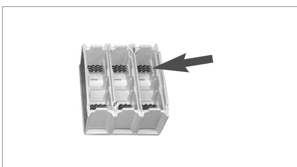
Крышка оснащена дугогасительными камерами и имеет окна для выхлопа продуктов горения. Последние образуются в процессе размыкания мостиковых контактов силового присоединения.
