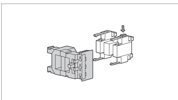
Катушка управления объединена с нижней частью магнитной системы. Ее демонтаж осуществляется нажатием на кнопку и выдвижением влево по специальным направляющим. Такой механизм позволяет упростить техническое обслуживание.
