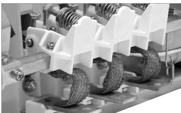
Гибкие соединения выполнены на основе плетения, уменьшающего вероятность обрыва проводов соединения в результате длительной эксплуатации.
