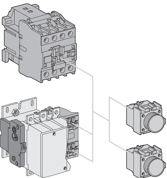
Монтаж приставок выдержки времени серии ПВИ производится при помощи защелки на фронтальную часть контактора серии КМИ и специальную крепежную панель контактора серии КТИ.
