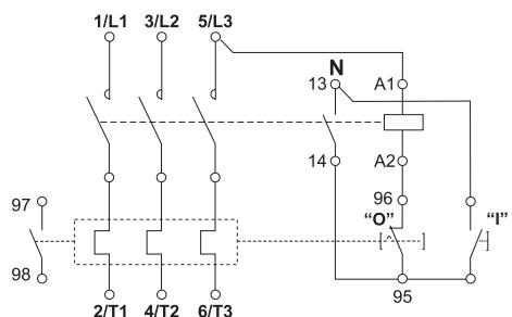
При управлении активными нагрузками (нагревательные цепи, цепи освещения), которые используют нулевой провод, рациональнее применять схему управления на 220 В.
