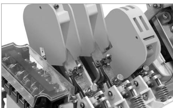
Конструкция крепления дугогасительных камер обеспечивает свободный доступ к силовым контактам, облегчая их техническое обслуживание и замену.
