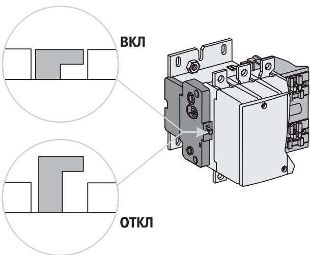
Положение контактной системы, то есть замкнуто или разомкнуто, можно определить по индикатору, расположенному в верхней части левой боковой крышки контактора.
